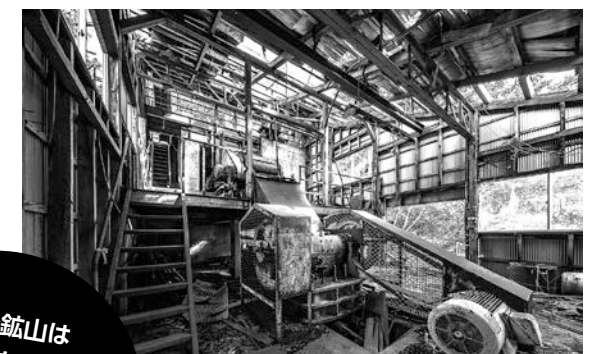
坑道内で使う圧縮空気を作ったS30年代初頭のコンプレッサー
