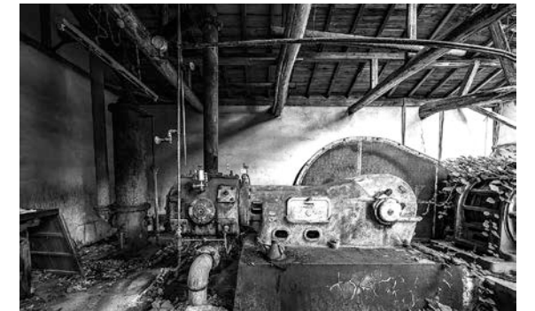
坑道内で使う圧縮空気を作ったS30年代初頭のコンプレッサー
